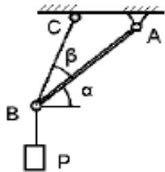
2. Груз весом  $P = 10 \text{ Н}$  подвешен на двух тросах АВ и ВС, составляющих с горизонтальной прямой углы  $\beta=15^\circ$  и  $\alpha=30^\circ$ . Определить усилия в тросах.
